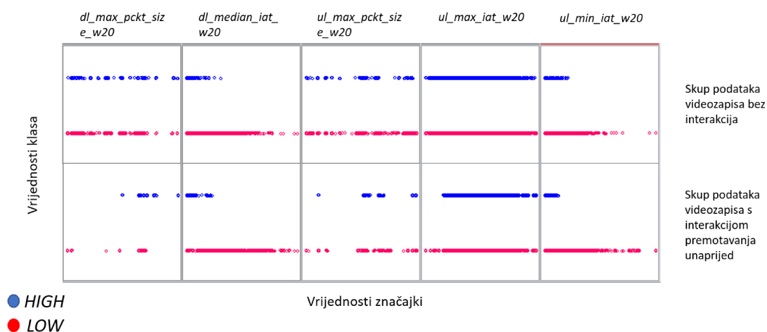
Slika 5.10 - Grafovi usporedbe skupa podataka bez i s interakcijom premotavanja videozapisa unaprijed za prikaz vrijednosti klase prosječne brzine kodiranja za odabrane značajke mrežnog prometa
